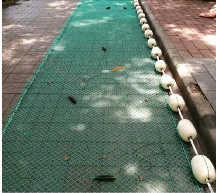
图 2.6.1-1 拦鲨网（含警示浮球）示意图
